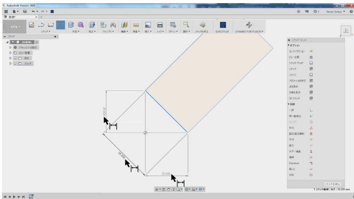
また、2 つのスケッチポイントや要素を選択することでその間の最短距離の寸法設定を行えます。動画では、マウスの移動による水平、垂直、斜め方向への寸法設定をご覧頂けます。
