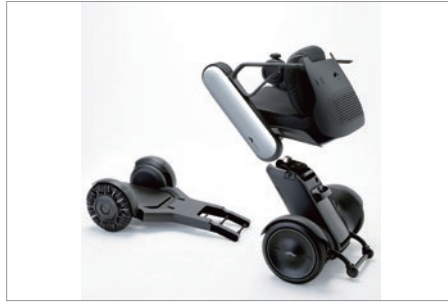
Model C はバッテリーを外して3分割が可能 [提供: WHILL株式会社]
