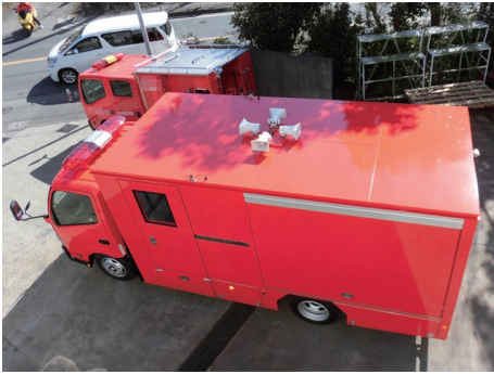
野口自動車手がけた「防災指揮車」の一例。火災や災害の現場で、活動の指揮を行ったり、調査を行うための車両だ。この車両では、天井部分に拡声器を設置。
